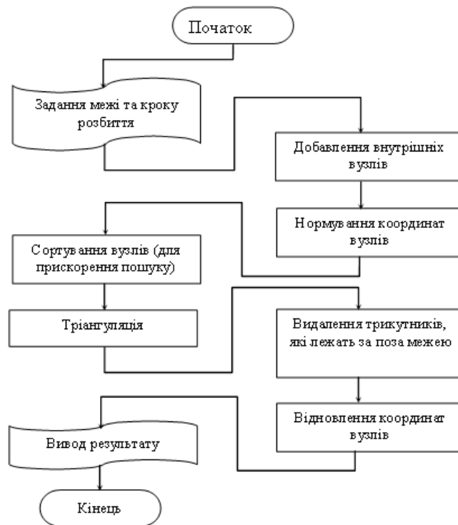
Рис. 1.5. Загальна блок-схема комбінованого алгоритму Ватсона-Лавсона.
